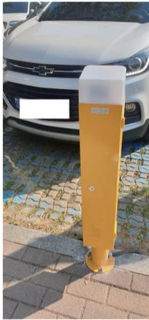
주차 가능 표지가 없는 차량이 장애인전용주차구역에 주차하면 경고음이 울리고 5분 이내에 3회에 걸쳐 경고 안내를 하고 이후 차량 이동이 이루어지지 않을 경우 과태료 처분 대상이 된다. 스마트 무인단속 시스템은 김포시청과 양촌읍·운양동 행정복지센터, 마산동 은여울공원·걸포중앙공원 5개소의 장애인전용주차구역 총 8면에 설치되었다.
